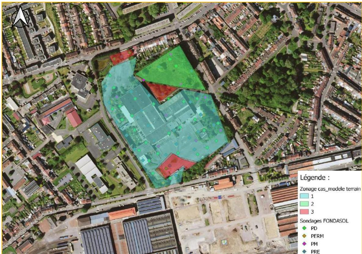
Figure 34. Carte indicative du zonage des différents cas de situation utilisés pour l'ébauche dimensionnelle des fondations
