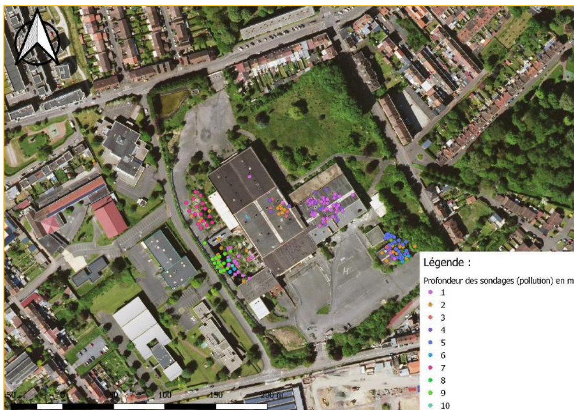
Figure 25. Cartographie de synthèse des sondages réalisés lors de l'étude de démolition et dépollution réalisée par SUEZ REMEDIATION
